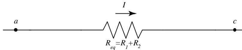
Figura 6.4: As resistências da figura 6.3 podem ser substituídas por uma resistência equivalente  $R_{eq} = R_1 + R_2$  que obtemos a mesma queda de potencial quando a  $R_{eq}$  é atravessada pela mesma corrente que no circuito da figura 6.3.
