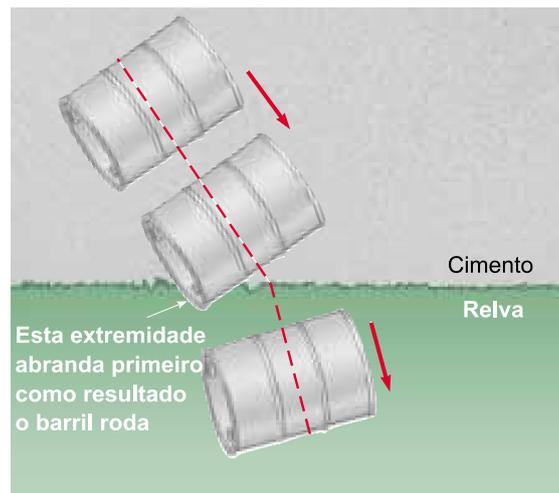
Figura 5.4: Um barril rolando por cima de dois pavimentos diferentes.
