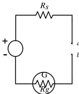
Figura 6.13: Um ohmímetro consiste numa bateria em série com um galvanómetro e uma resistência  $R_s$ , escolhida de modo a que quando os terminais  $a$  e  $b$  são postos em curto-circuito, a corrente através do galvanómetro provoca uma deflexão completa na escala escolhida.
