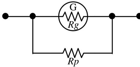
Figura 6.11: Um amperímetro consiste num galvanómetro cuja resistência é  $R_g$  e uma pequena resistência em paralelo  $R_p$ .
