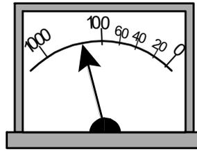
Figura 6.14: Quando uma resistência  $R$  é ligada em  $a$  e  $b$ , a agulha do galvanómetro deflecte uma quantidade que depende do valor de  $R$ . A escala do galvanómetro é calibrada de maneira a dar uma leitura em ohms.
