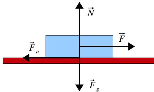
Figura 2.1: Um corpo sujeito à força de atrito.
