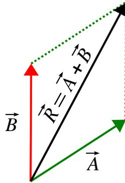
Figura 1.2: Método do paralelogramo.
