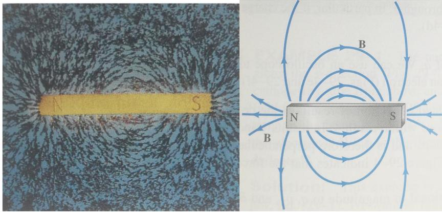
Figura 7.6: Campo magnético  $B$  perto de um íman e as linhas de indução magnética. À esquerda o que acontece na realidade, à direita o que preconiza a teoria.
