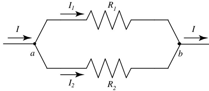
Figura 6.5: Duas resistências estão em paralelo quando estão juntamente ligadas em ambas as extremidades de maneira que a queda de potencial é a mesma nas duas.
