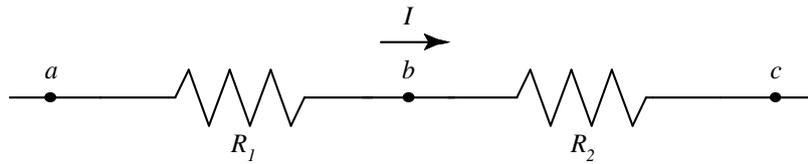
Figura 6.3: Duas resistências em série são atravessadas pela mesma corrente.
