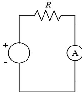
Figura 6.9: Para medir a corrente na resistência  $R$ , um amperímetro é colocado em série com a resistência para que receba a mesma corrente que a resistência.
