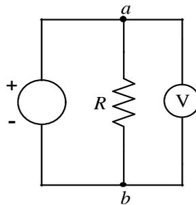
Figura 6.10: Para medir a queda de potencial numa resistência, um voltímetro é colocado em paralelo com a resistência para que a queda de potencial seja a mesma no voltímetro e na resistência.
