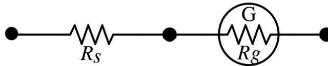
Figura 6.12: Um voltímetro consiste num galvanómetro cuja resistência é  $R_g$  e uma grande resistência em série  $R_s$ .
