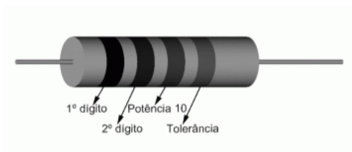
Figura 6.8: Aspecto físico de uma resistência.
