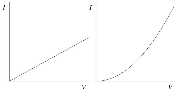
Figura 6.1: (a) Material ôhmico. (b) Material não ôhmico.
