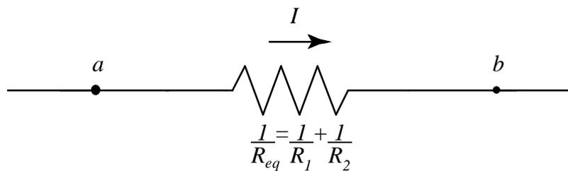
Figura 6.6: As duas resistências da **Fig.5.** podem ser substituídas por uma resistência equivalente  $R_{eq}$  que está relacionada com  $R_1$  e  $R_2$  pela fórmula  $\frac{1}{R_{eq}} = \frac{1}{R_1} + \frac{1}{R_2}$ .
